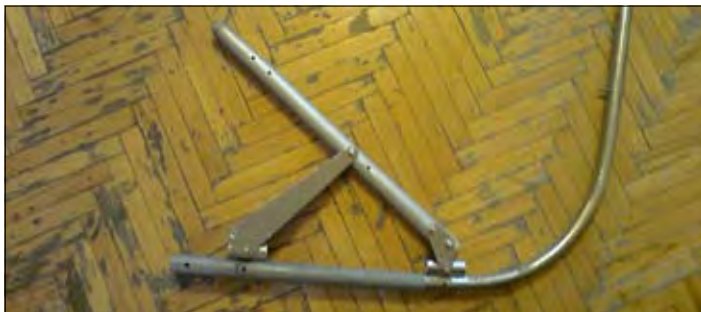
Натяжитель каркаса, «распирающий» оболочку корпуса
