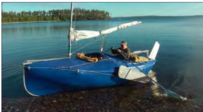
При отходах от берега или к подходу к нему можно воспользоваться веслами. Места установки уключин позволяют грести как сидя по курсу, так и спиной вперед. А если снять парусное вооружение (на это требуется 10 минут), лодка превращается в гребную с неплохими ходовыми характеристиками
