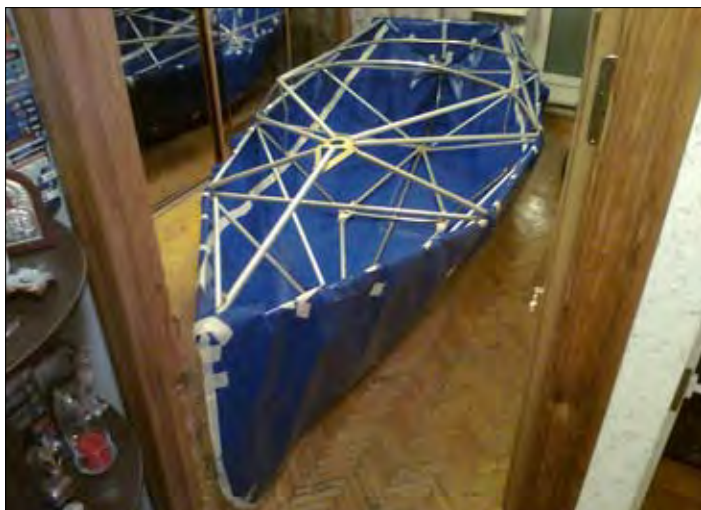
Процесс изготовления оболочки: «семь раз примерь, один раз отрежь». Все работы велись в условиях городской квартиры на собранном каркасе «по месту»
