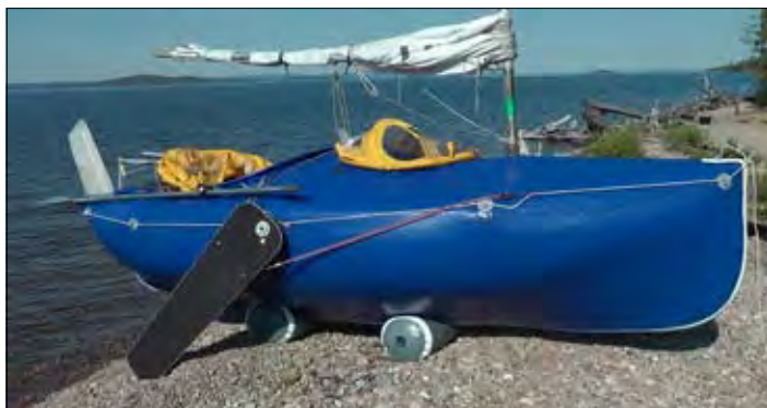
На берегу. От заваливания на бок предохраняют шверцы, зафиксированные в нужном положении
